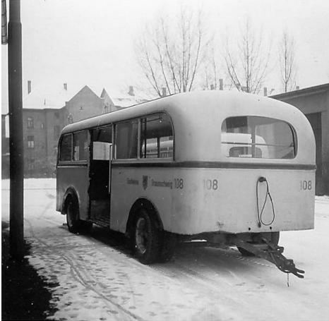
Omnibusanhänger 108 (Wismar 1943), nach Umbau der Lenkachse bei Luther & Jordan und HU im Bf Altewiek. Hinter dem Wagen steht ein neu angelieferter Unterflurbus 5000T der Reihe 2"-5"
